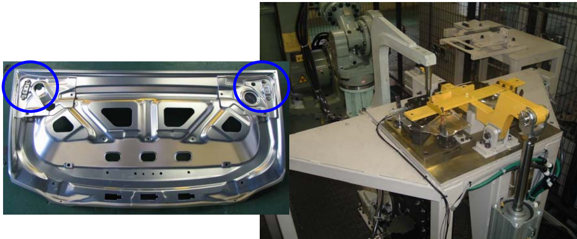
Technologie d'assemblage par points de Mazda pour fer et aluminium par l'emploi de la chaleur de friction (couvercle du coffre et jonc de maintien de la MX-5)
